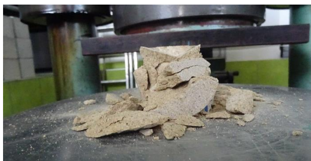
Pohled na porušený vzorek kamene LV3.1 při hodnotě krychelné pevnosti 42,0 MPa.
