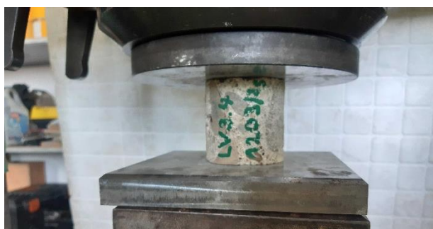
Pohled na vzorek 1203/25, porušení při hodnotě 15,0 MPa. Ložný beton.
