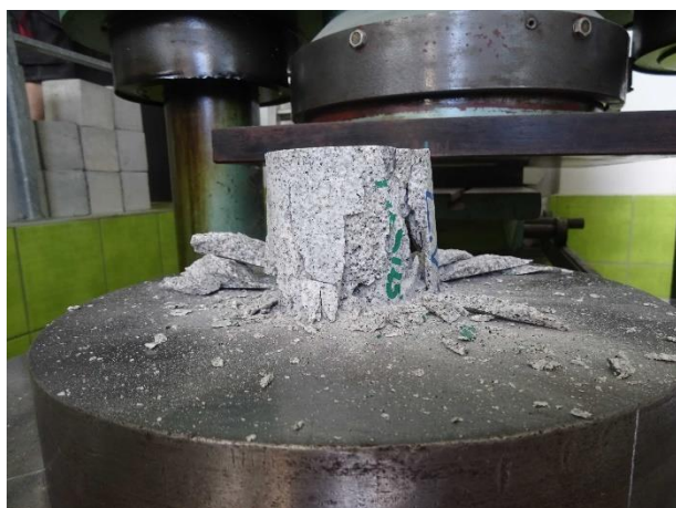
Pohled na porušený vzorek při hodnotě krychelné pevnosti 143,6 MPa.
