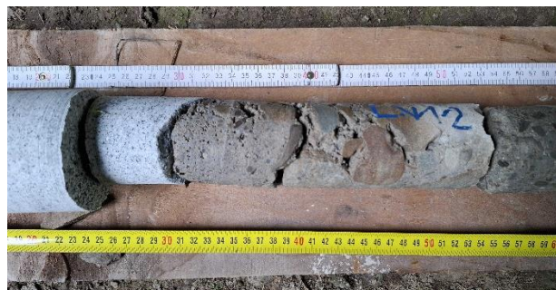
35-60 cm, následuje beton opěry, říční kamenivo netříděné,
