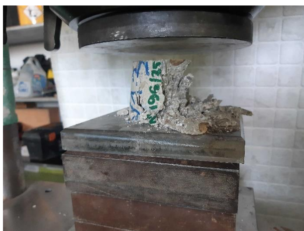
Pohled na porušený vzorek 1196/25 při hodnotě krychelné pevnosti 27,1 MPa.
