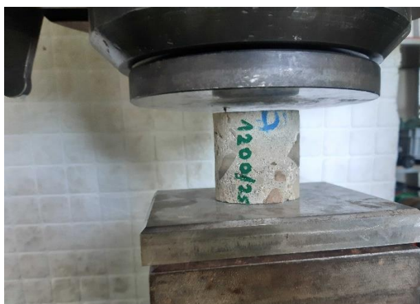
Pohled na vzorek 1200/25, porušení při hodnotě 18,5 MPa.
