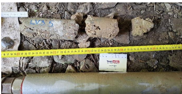
Pohled na strukturu 200-240 cm, kámen s ložným betonem, polosoudržná struktura,
