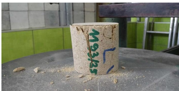
Pohled na porušený vzorek kamene LV3.1 při hodnotě krychelné pevnosti 52,8 MPa.
