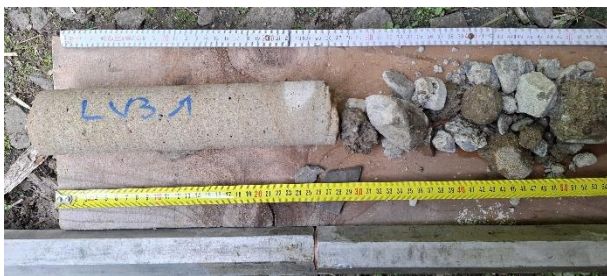
Pohled na strukturu 0-55 cm, pískovcový kámen, rozpadlý ložný beton s kusy kamene.
