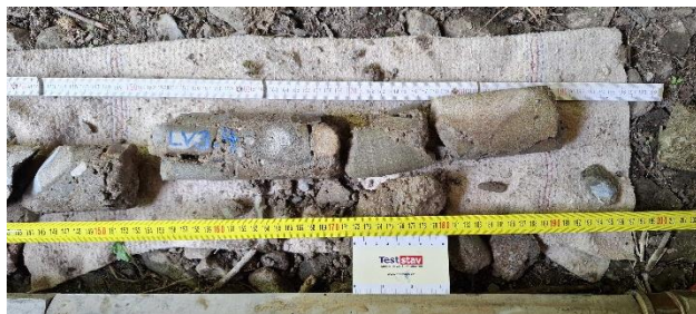
Pohled na strukturu 150-200 cm, kámen s ložným betonem, polosoudržná struktura,
