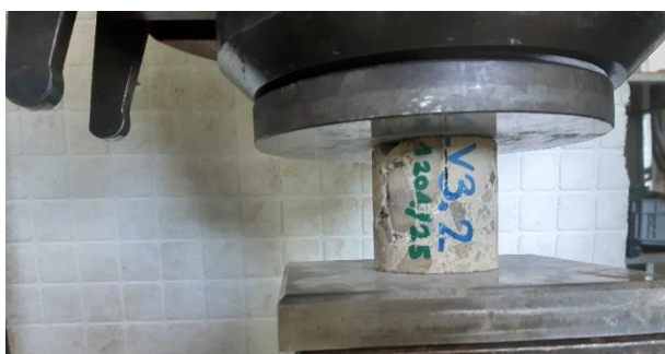
Pohled na vzorek 1201/25, porušení při hodnotě 13,4 MPa. Ložný beton.
