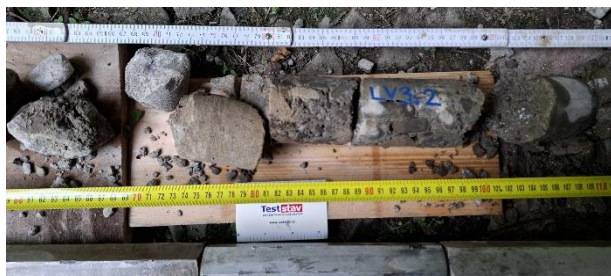
Pohled na strukturu 60-110 cm, pískovcový kámen, ložný beton s kusy kamene.
