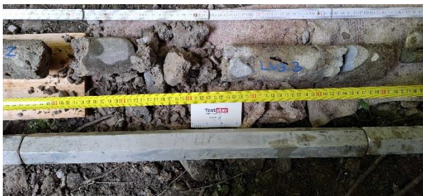
Pohled na strukturu 110-150 cm, kámen s ložným betonem, polosoudržná struktura,
