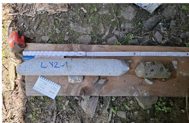
Byla detekována základací řada obkladového kamene, následoval beton základu.
