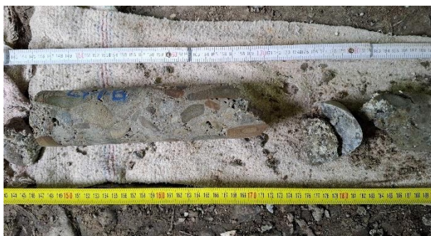
140-190 cm beton opěry se zvýšenou pórovitostí
