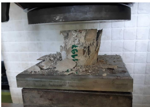
Pohled na porušený vzorek 1197/25 při hodnotě krychelné pevnosti 27,4 MPa.
